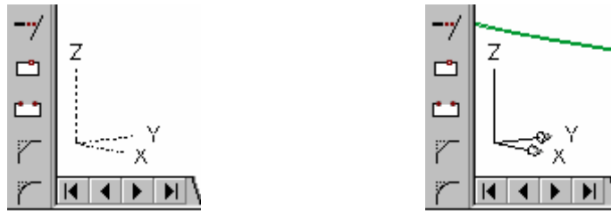
شکل 1-37-الف) نماد دستگاه مختصات استاندارد در حالت دید 3 بعدی شکل 1-37-ب) نماد دستگاه مختصات استاندارد در حالت دید پرسپکتیو (3 بعدی با نقطه فرار)
