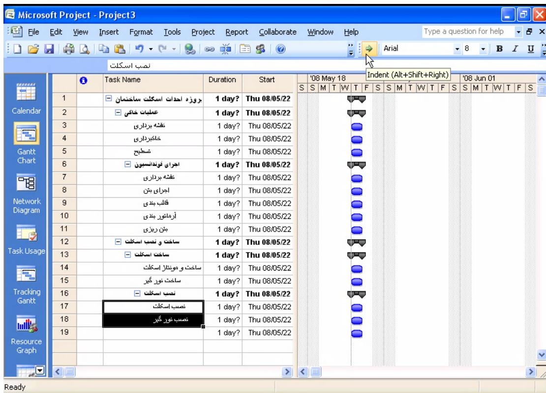
حال اگر در بیان پروژه مادر دچار مشکل شدید و یا خواستید آن را حذف کنید ابتدا زیر مجموعه ها آن را انتخاب کنید و بعد روی گزینه Out dent که خلاف جهت Indent است کلیک می کنیم. و یا وارد منوی Project شده روی گزینه Out line و بعد روی گزینه Out dent را انتخاب می کنیم.
