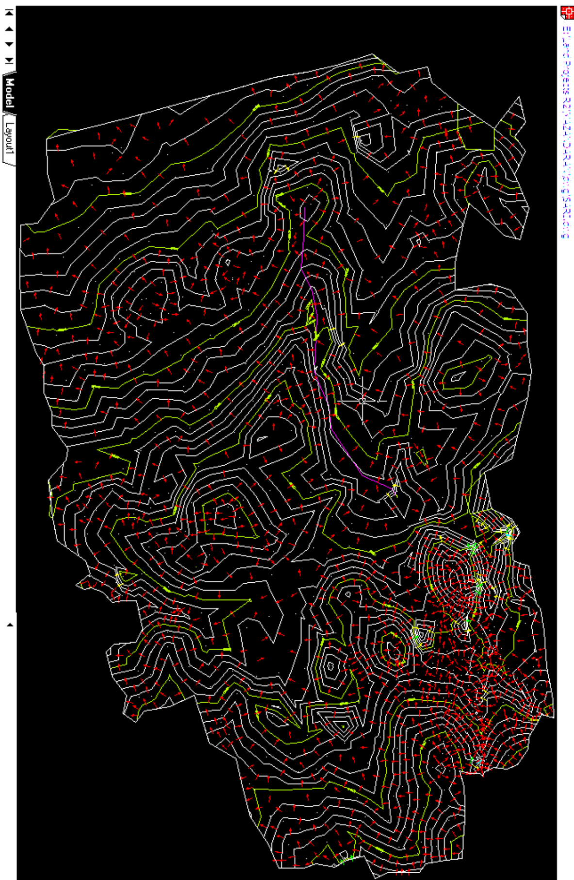
شکل ۳-۴ : تقسیم بندی منطقه بر اساس شیب در روی منحنی میزان
