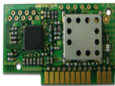
دارای پهنای باند 720 Kbs و 10 متر قدرت انتقال (در صورت تقویت تا 100 متر قابل افزایش است ) می باشد. این تکنولوژی که از سیستم گیرنده‌گی و فرستنده‌گی در جهت مناسب استفاده می کند. قادر است امواج رادیویی را از میان دیوار و دیگر مواد غیر فلزی عبور دهد. اگر امواج مزاحم دستگاه ثالثی باعث تداخل شود انتقال اطلاعات کند می شود ولی متوقف نمی شود.
