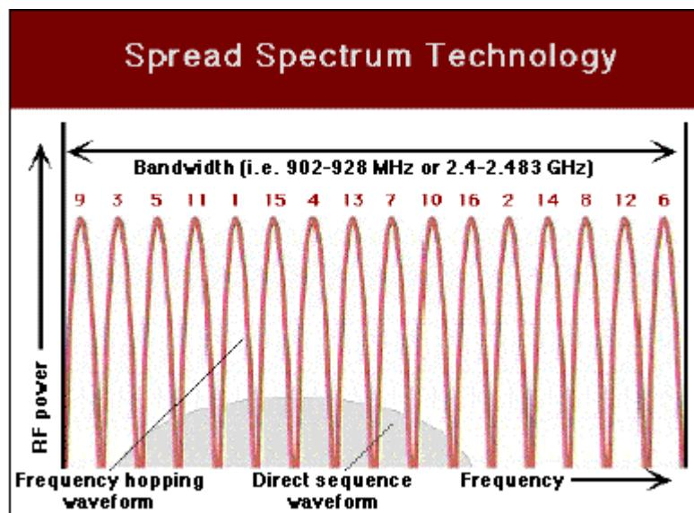
در مورد بلوتوث این عمل تغییر فرکانس توسط دستگاه فرستنده حدود 1600 بار در ثانیه اتفاق می افتد. و این بدان معنی است که تعداد دستگاه های بیشتری در آن واحد می توانند از یک بخش محدود از باند فرکانس رادیویی استفاده کنند.
