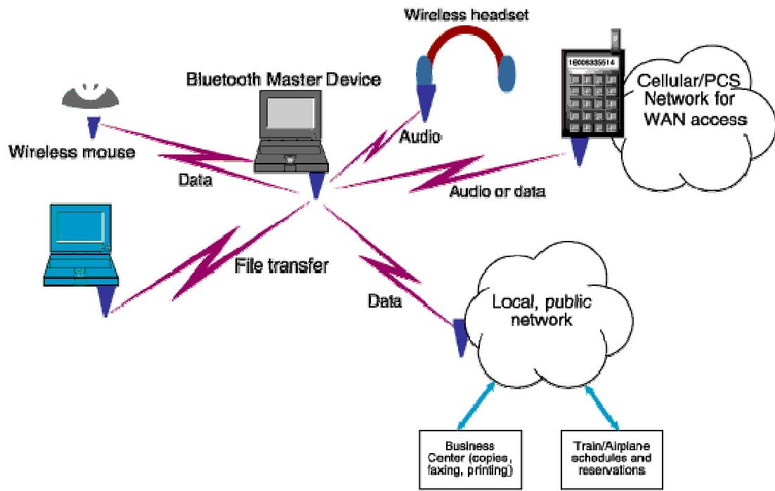
وقتی که یک شبکه piconet برقرار می شود دستگاه های حاضر در این شبکه همانطور که قبل توضیح دادیم شروع به استفاده از سیستم جهش فرکانس می کنند و مرتبا فرکانس سیگنال های خود را بطور اتفاقی در یک طیف مشخص تغییر می دهند تا با اینکار هم در دسترس یکدیگر باشند و هم اینکه از تداخل piconet آنها با دیگری که ممکن است در همان اتاق برقرار باشد جلوگیری شود. حالا اجازه بدهید با یک مثال با این تکنولوژی بیشتر آشنا شویم.
