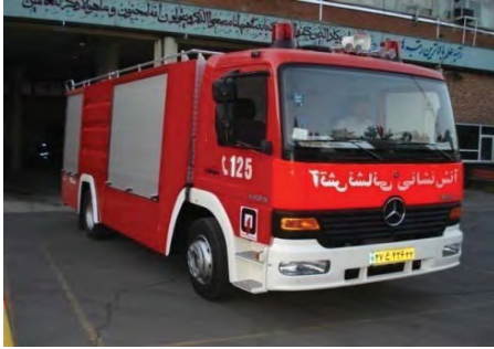
پسرو حریق (بنز آتگو تک کابین)
