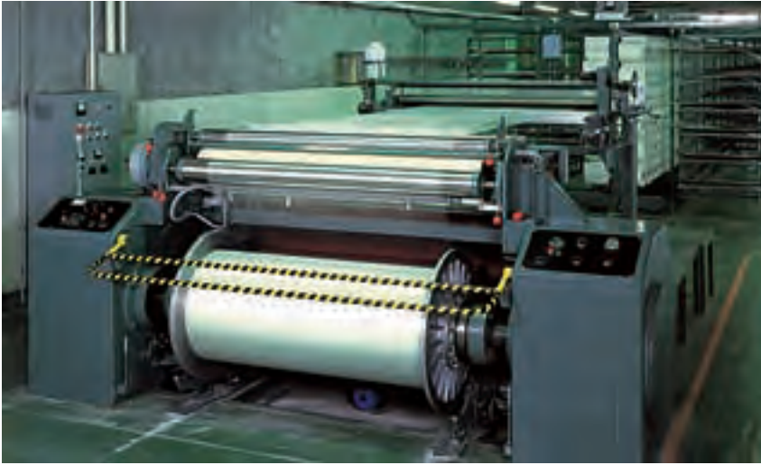
شکل ۲-۵ - دستگاه چله پیچی مستقیم
