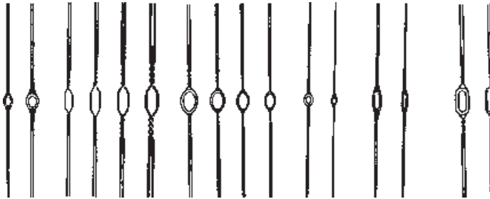
شکل ۴-۱۴- انواع میل میلک‌های ماشین بافندگی
