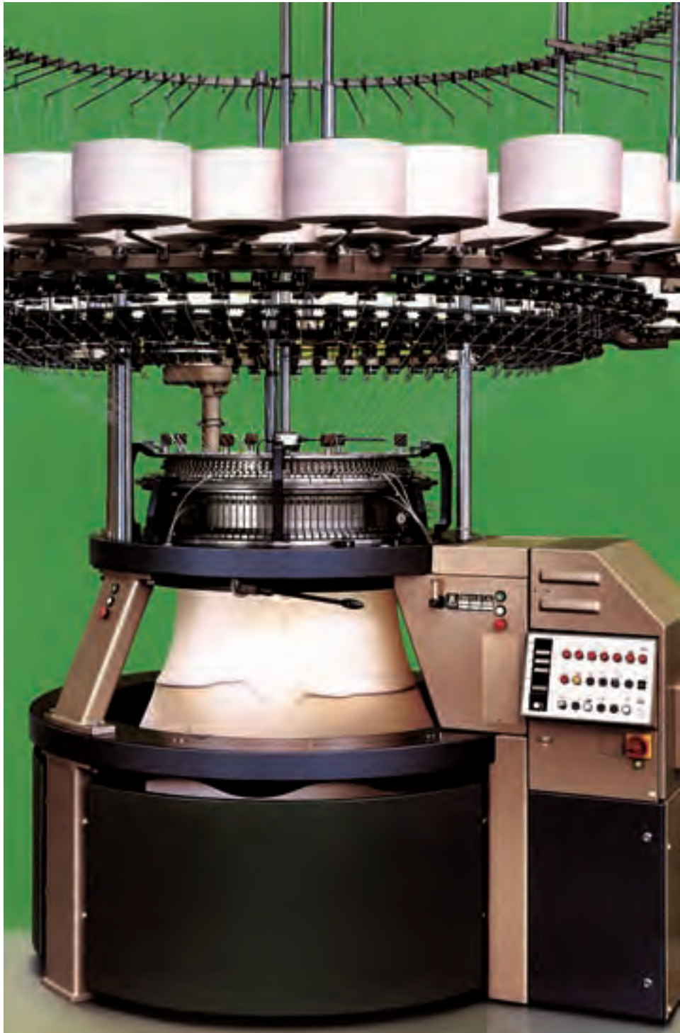
شکل ۱۰-۸ - نمای ظاهری ماشین گردباف یک سیلندر مجهز به سوزن زیانه‌دار
