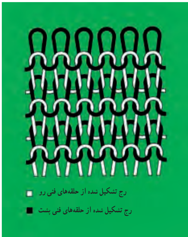
شکل ۱۰-۶- ساختمان بافت ساده دوبله سیلندر
