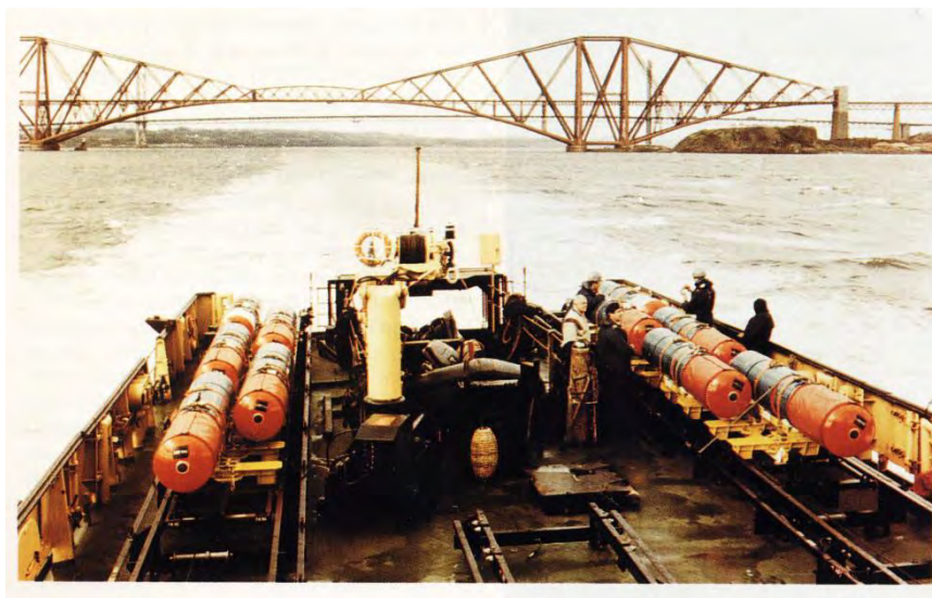
شکل (۷/۴) پرتاب مین های عمقی از ریلهای پرتاب مین یک شناور مین گذار
