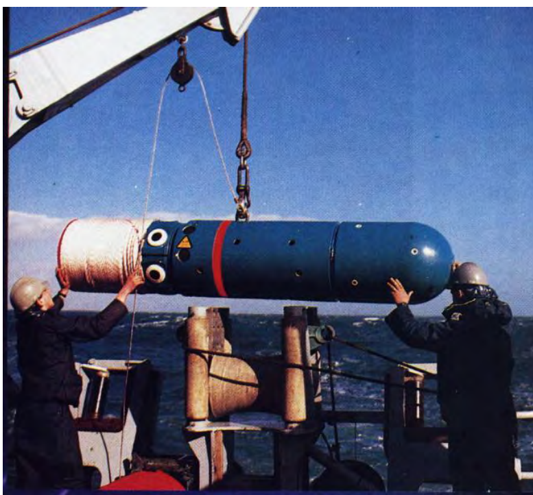
شکل (۶/۴) مین گذاری یک مین عمقی با استفاده از یک کشتی معمولی
