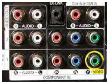
**چه کارایی دارد:** پورت کامپوننت در ابتدا اولین گزینه مطرح شده برای ارسال سیگنال های کیفیت بالای HD بود. همانند کامپوزیت این پورت هم از کابل های RCA استفاده می کند. تفاوت این دو چیست؟ در اینجا شما دو ورودی صدا و سه ورودی تصویر در اختیار دارید.
