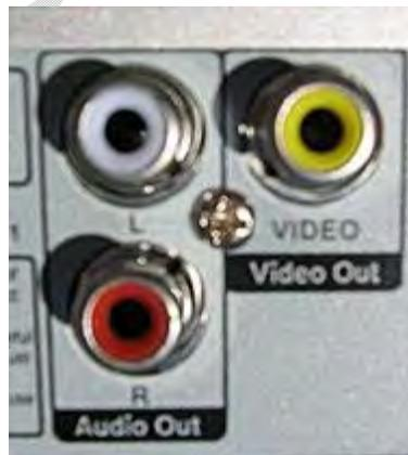
**چه کارایی دارد:** پورت خروجی ویدیو (و خروجی صدا اگر بر روی تلویزیون شما باشد) معمولاً به صورت یک پورت کامپوزیت است و برای ارسال محتوای تلویزیونی به ابزارهای دیگر برای ضبط و نگهداری یا انتقال است.
