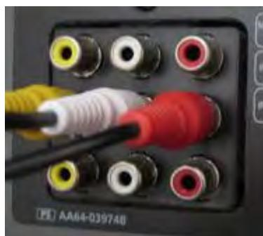
**چه کارایی دارد:** این پورت برای دریافت سیگنال صوتی استریو و سیگنال تصویر استاندارد SD توسط کابل کامپوزیت است. پورت کامپوزیت سال های زیادی است که استفاده می شود و تقریباً هر دستگاهی را با استفاده از آن می توان به تلویزیون متصل کرد.
