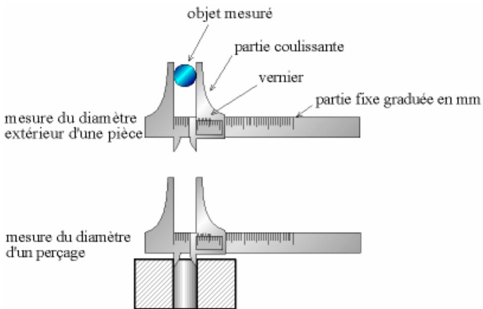
یکی از ابزارهای دقیق در اندازه گیری کولیس ابزاری است که می توانیم اندازه تا ۱ میلیمتر را با آن اندازه گیری کنیم. کولیس تشکیل شده است از یک خط کش اصلی که روی آن تقسیم بندی انجام شده که می توانند به صورت میلیمتری یا اینچ باشد. دوم، فک ثابت کولیس می باشد، سوم، فک متحرک کولیس، چهارم، شاخکهای داخل سنج است، پنجم، شاخک عمق سنج است، ششم یکسری اندازه گیری روی فک متحرک کولیس است که به آن ورنیه می گویند.
