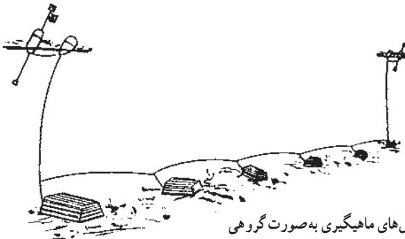
شکل ۴-۷- نصب قفس به صورت منفرد و نحوه بالا کشیدن آن با استفاده از وینچ
