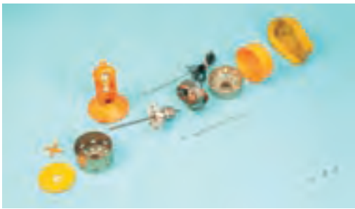
شکل ۱۸-۸ - نمایش ظاهری و اجزای یک واترپمپ
