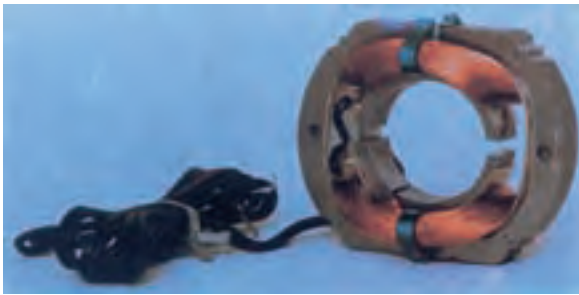
شکل ۸-۱۴ - استاتور و هسته پمپ آب
