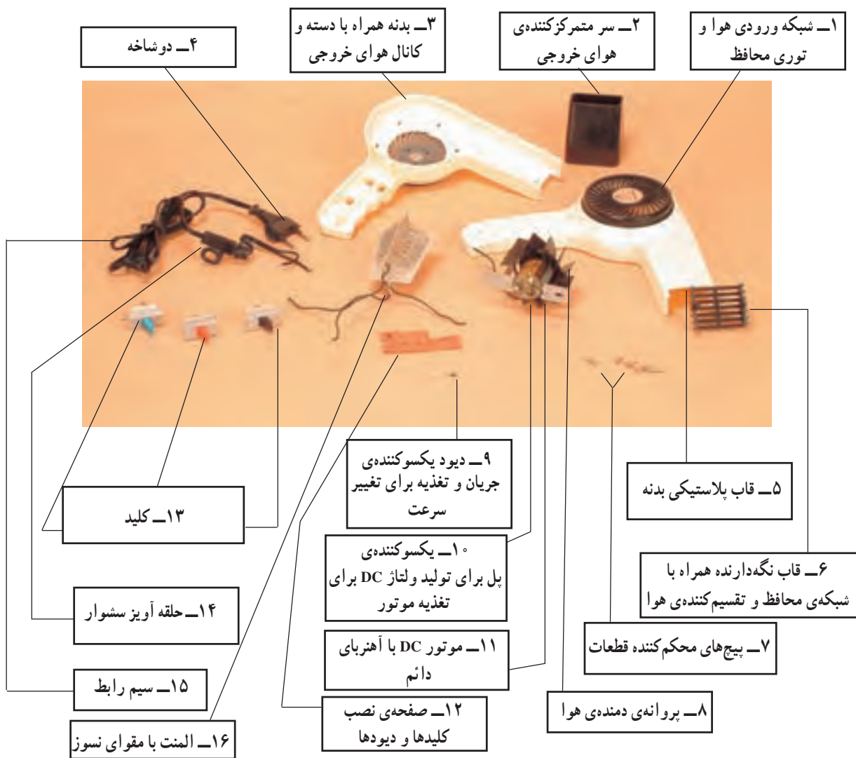
شکل ۴۲-۶ اجزای ساختمانی یک نمونه سشوار
