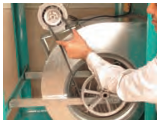
الف- طرز قرار گرفتن تسمه روی پولی‌ها
