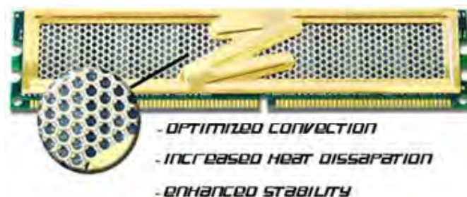
شکل 2: خنک کننده لانه زنبوری ، تکنولوژی XTC
