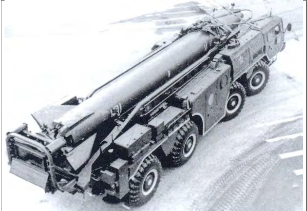
سکوی پرتاب خودکششی 9P117M یک چهارچوب عمودساز ساده داشت که فاقد ویژگی جرثقیل روکار با جکهای هیدرولیک مربوط به آن بود (وزارت دفاع آمریکا).
