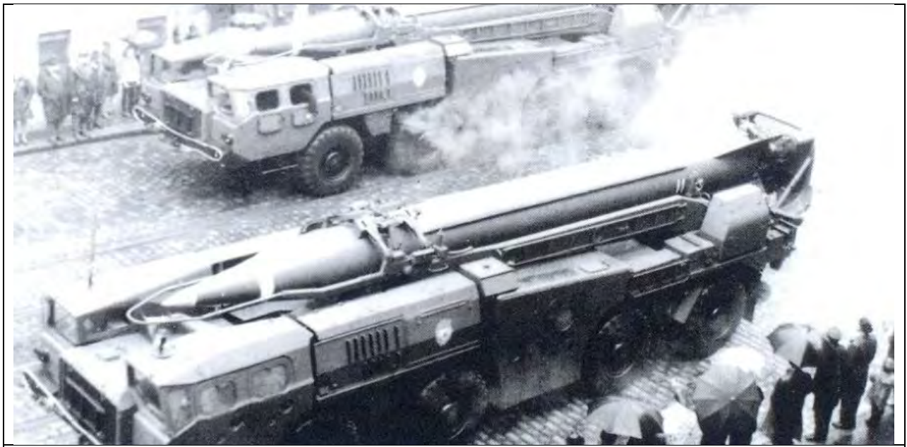
دو فروند سکوی پرتاب 9P117M در مراسم رژه‌ای در سپتامبر ۱۹۷۲ در پراگ. چهارچوب عمودساز ساده شده به خوبی در این
