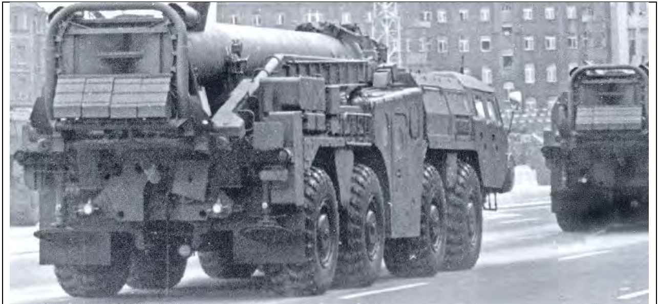
نمای دیگری از یک سکوی 9P117M آلمان شرقی از سریهای اولیه تولید با دو دریچه بر روی کابین پمپاژ مرکزی سمت راست. (وزارت دفاع آمریکا)
