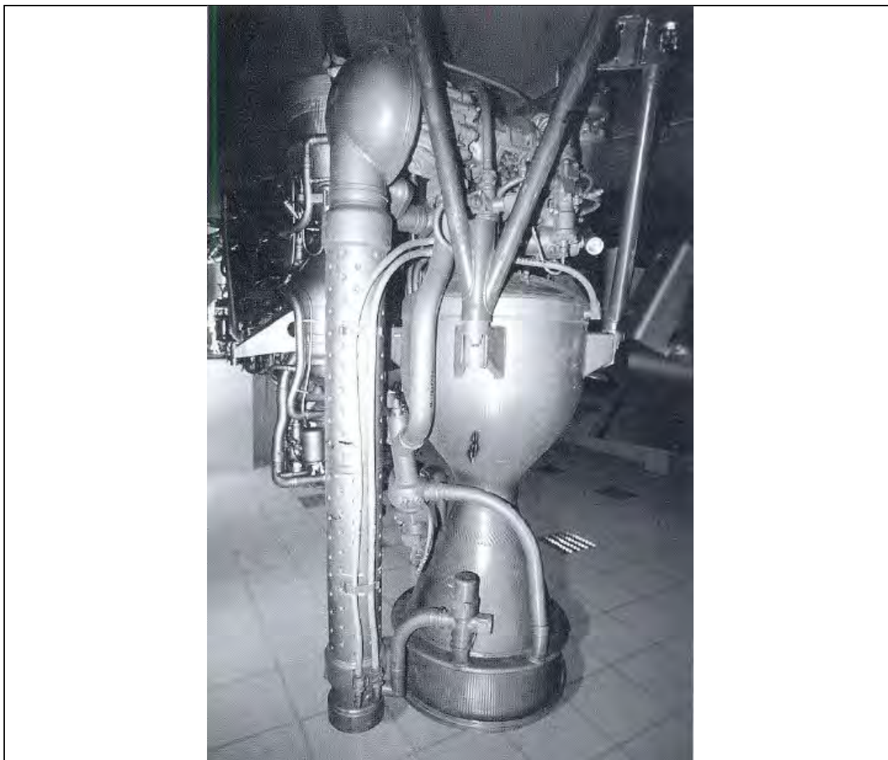
اسکاد بی با موتور راکت چرخه-باز 9D21 ایسایف کار می‌کند. بالای محفظه احتراق توربوپمپ قرار دارد که سوخت را تزریق می‌می‌کند و لوله سمت چپ، آگزوز توربوپمپ است.
