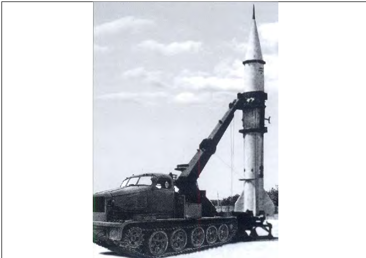
موشک اولیه R-11 که با استفاده از کِشنده 8U227 (مبتنی بر کِشنده سنگین AT-T) به موقعیت پرتاب یدک کشیده شده و عمود شده است، در این تصویر بر روی قنداق پرتاب 8U22 دیده می‌شود.
