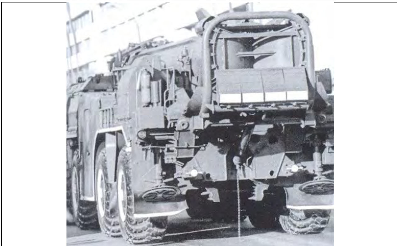
در این نمای پشت از سکوی پرتاب خودکششی 9P117M1 شوروی، قنداق پرتاب بزرگ 9N117 که هنگام حمل و نقل، پشت موشک لولا می‌شود به خوبی دیده می‌شود (وزارت دفاع آمریکا).
