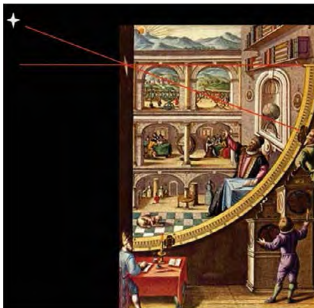
شکل ۱-۳: یک ربع دایره که تیکو براهه از آن برای اندازه‌گیری ارتفاع ستاره یا سیاره هنگام عبور از نصف النهار (رو به جنوب) استفاده می‌کرد.
