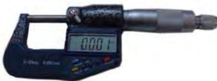
یکی دیگر از ابزارهای دقیق میکرومتر می باشد، که در انواع مختلف ساخته می شود، به این شکل که ما میکرومتر خارج سنج داریم که می تواند سطح خارجی اجسام را اندازه بگیرد و میکرومتر داخل منبع که سطح داخلی اجسام را اندازه گیری می کند. میکرومتر نیز از بخشهای مختلفی تشکیل شده است، که عبارتند از:
