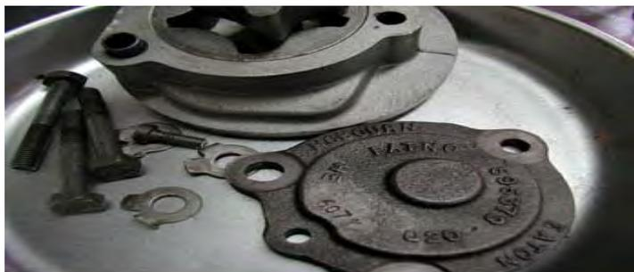
مثل : آلترناتور که وظیفه جریان الکتریسته موتور را تأمین می کند. سپس واتر پمپ که وظیفه گردش آب در موتور را برعهده دارد و یکی از قطعات سیستم خنک کاری است. قسمت دیگر اوایل پمپ است که وظیفه مکش روغن از کارتر و ارسال آن به مدار روغن کاری است.
