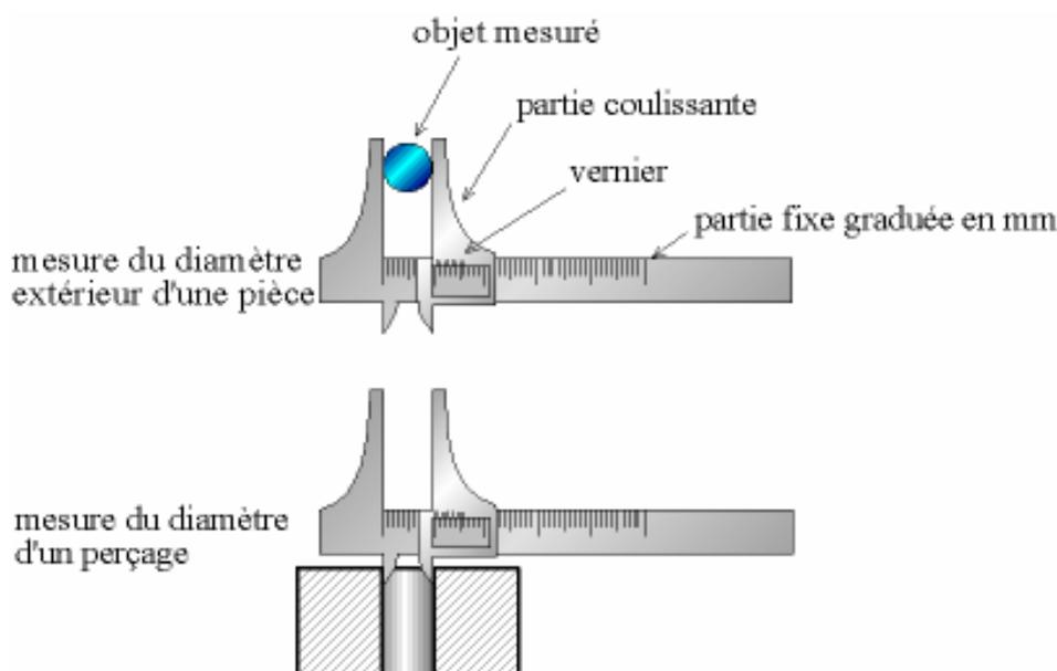
یکی از ابزارهای دقیق در اندازه گیری کولیس است، کولیس ابزاری است که ما می توانیم اندازه تا ۱ میلیمتر را با آن اندازه گیری کنیم. کولیس تشکیل شده است از یک خط کش اصلی که روی آن تقسیم بندی انجام شده که می توانند به صورت میلیمتری یا اینچ باشد. دوم، فک ثابت کولیس می باشد، سوم، فک متحرک کولیس، چهارم، شاخکهای داخل سنج است، پنجم، شاخک عمق سنج است، ششم یکسری اندازه گیری روی فک متحرک کولیس است که به آن ورنیه می گویند.
