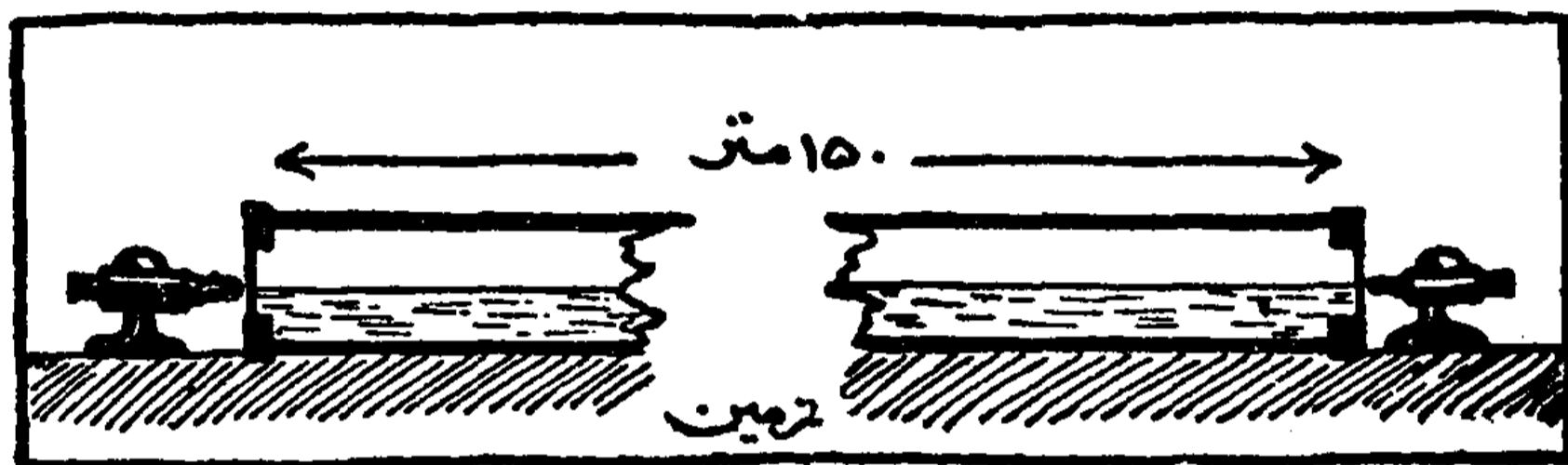
شکل ۲۲ : دستگاه مایکل سن برای مطالعه جزرومد در شرایط آزمایشگاه
